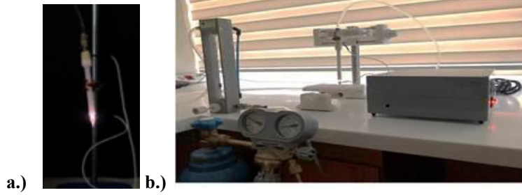
Şekil 1. Bakteri kuyucuklarına direkt ışıma yapabilen atmosferik plazma sistem imalatı
