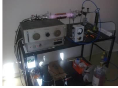
Şekil 2. PHP polimerlere plazma modifikasyonu yapabilen vakum plazma sistemi imalatı
